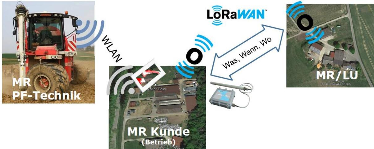
Abb. 16: LoRaWAN-Netzwerk Technik – Betrieb - Dienstleister
