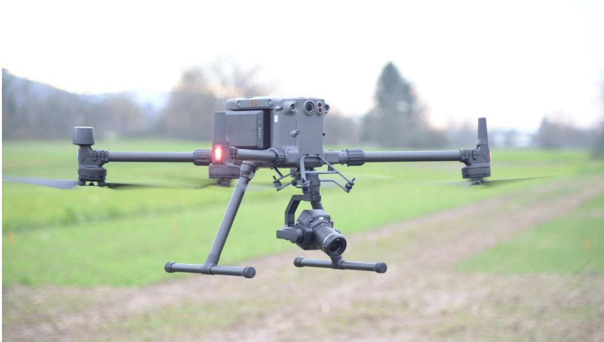
Abb. 17: Befliegung der Versuchsfläche mit Drohne (M300 mit sehr hochauflösender Kamera)
