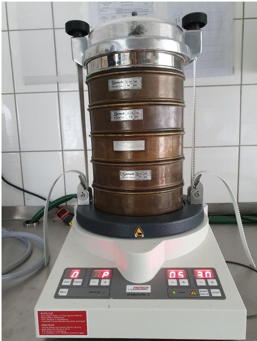
Abbildung 4: Wurf-Siebmaschine "Analysette 3" der Firma FRITSCH
