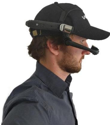
*Abbildung 8: HMT-1 Augmented-Reality-Brille von Realwear im Einsatz.*
