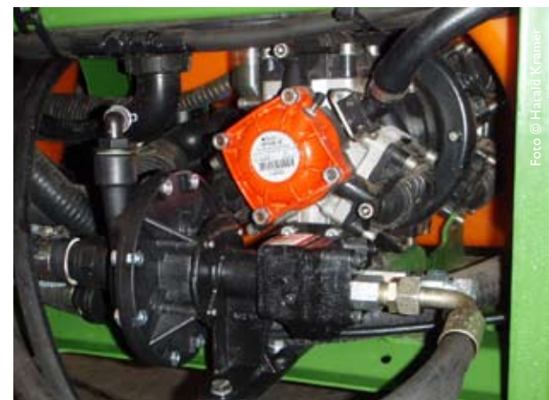
Spritzen können mit einer Reinigungspumpe für das kontinuierliche Innenreinigungssystem nachgerüstet werden.
