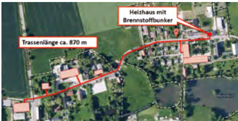
Das geplante Nahwärmenetz im Erlauer Ortsteil Schweikershain in Sachsen soll den Energiebedarf eines Sportkomplexes, des Pfarramtes, einer Lernförderschule und eines Altenpflegeheims (v.l.n.r.) über den Einsatz regionaler Holzhackschnitzel decken.
