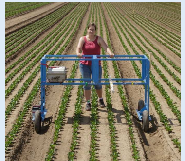
Versuche zur Erkennung von Blattlausbefall mit dem Fieldbike auf dem Praxisbetrieb. Foto: © Limbach, FZJ.
