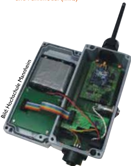
Abb.: Multiparametersensor (rechts) und Funkmodul (links)
