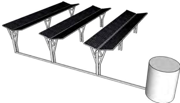
Abb. 49: Konzept einer Regenauffangvorrichtung mit Speichertank. © Fraunhofer ISE
